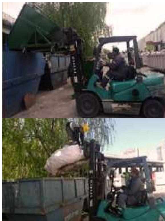
Figura 28: Contenedor basculante para vidrio con autoelevador del Nodo. Fuente: Dir. Nacional de Economía Popular (MDS).
